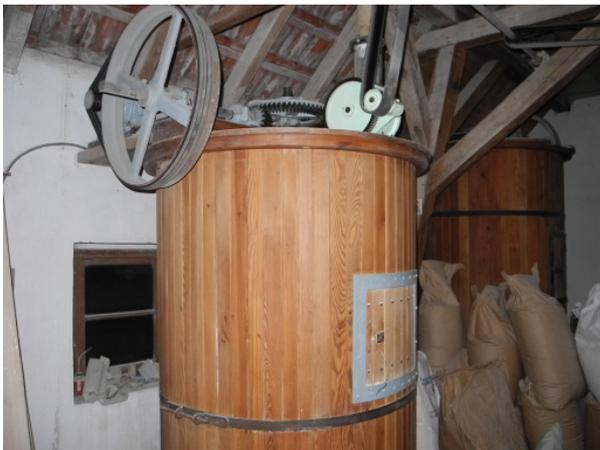
Nach dem eigentlichen Mahlgang im steinernen Mühlstein durchläuft das Mehl und die übrigen Getreidebestandteile (z.B. Spelzen) noch ein ganzes System aus Rohrleitungen, Abscheidern und unterschiedlich feinen Sieben, um erstens nur die Bestandteile abfüllen zu können, die für einen bestimmten Zweck bestimmt sind und zweitens unterschiedlich fein gemahlene Mehle voneinander trennen zu können.
