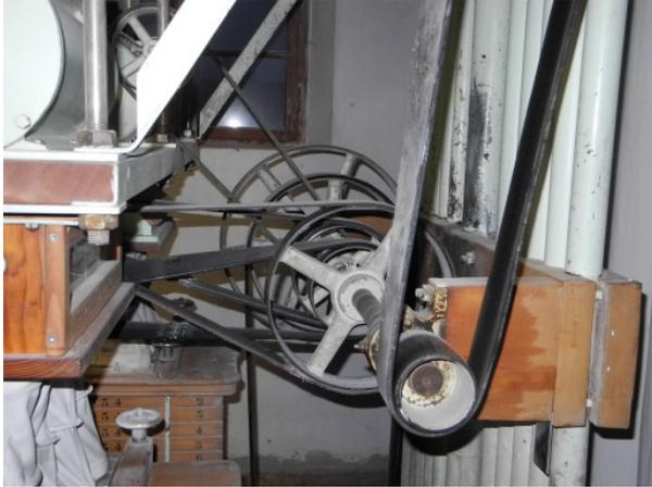
Die Technik in der Mühle ist über 50 Jahre alt; verschiedene Verschleißteile – wie z.B. Treibriemen oder Manschetten aus Textilfaser musste Rémi Jung inzwischen allerdings erneuern. Da diese Materialien keine Serienartikel sind, mussten sie eigens in Handarbeit auf Maß angefertigt werden.
