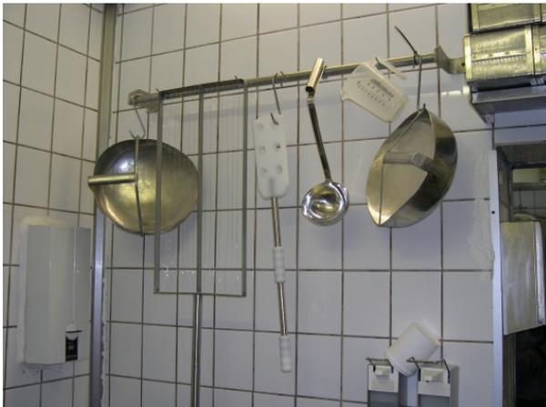
Mit der Harfe wird der fest gewordene Kern im Kessel zerteilt, bevor der junge Käse in Formen umgefüllt wird. Durch die Perforation der Formen kann die überschüssige Molke ablaufen.
