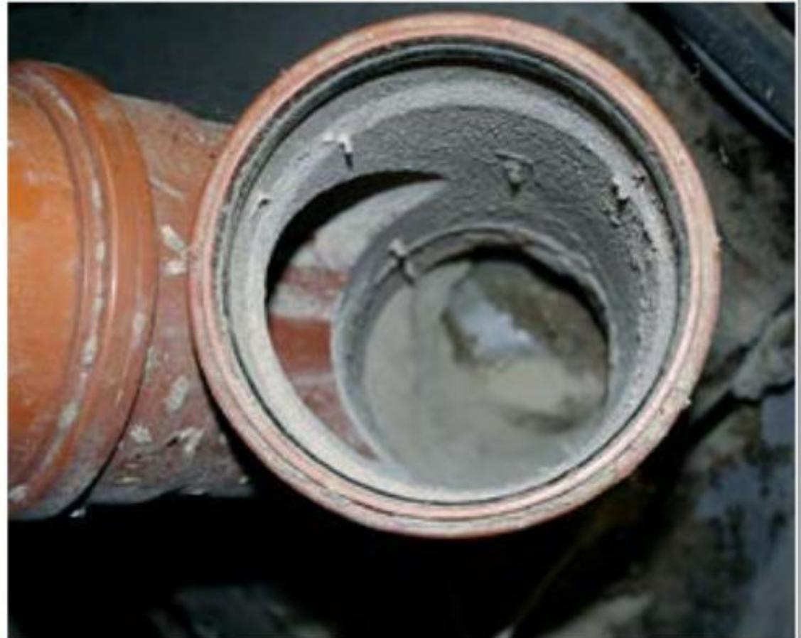
*Bilder 49 und 50: Die Dosiereinrichtung und Förderrohre müssen sauber und frei von Ablagerungen sein, um Verschneidungen von medikiertem Futter zu vermeiden. Hier sieht man schlechte Beispiele.*
